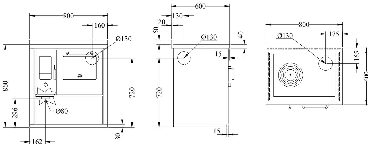
Versione con uscita fumi a destra. La versione con uscita fumi a sinistra è simmetrica.
